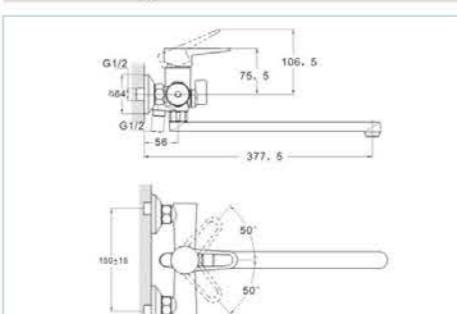
Технологія виробництва: лиття під тиском
