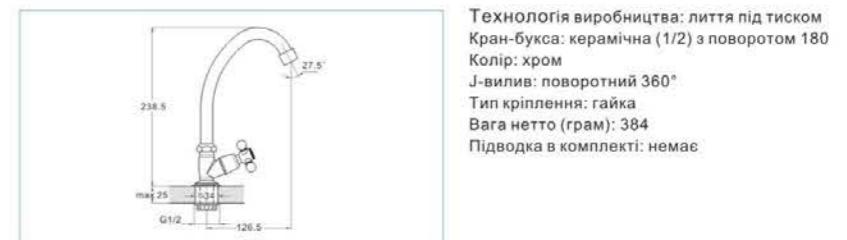
Технологія виробництва: лиття під тиском
