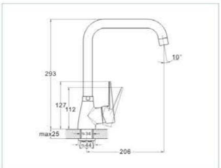
Технологія виробництва: лиття під тиском
