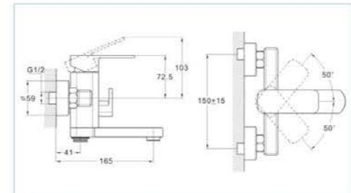
Технологія виробництва: лиття під тиском
