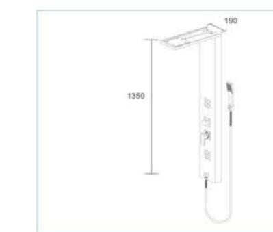
Корпус: нержавіюча сталь AISI 304, розмір 1350x190 мм
