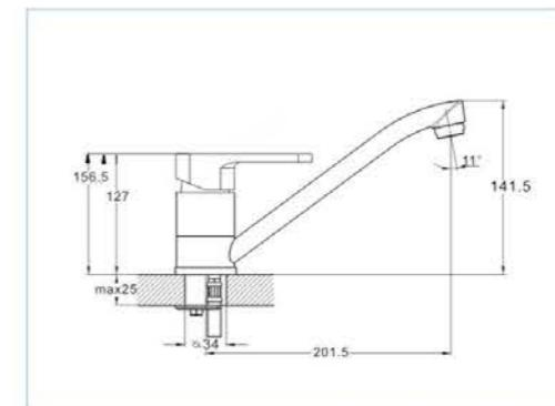
Технологія виробництва: лиття під тиском
