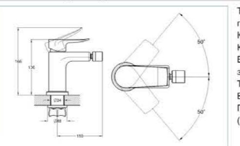
Технологія виробництва: лиття під тиском
