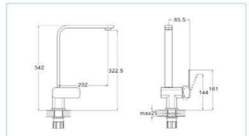
Технологія виробництва: лиття під тиском
